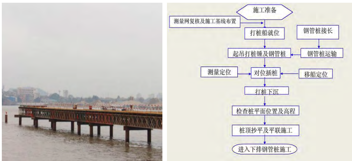
图 4.4-2 栈桥结构形式及施工工艺流程
